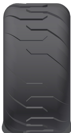
Falta de pressão
